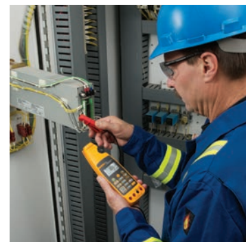
Mät process- och andra automations- 4 till 20 mA-signaler utan att bryta slingan.
