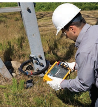
Transformortillbehör som kan klämmas fast för jordslingsmätningar på krafttom.
