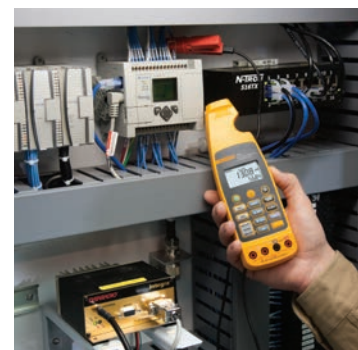
Mät process- och andra automations- 4 till 20 mA-signaler utan att bryta slingan.
