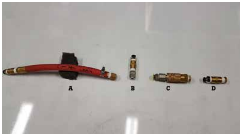
Afbeelding 5: De vier lektypen die tijdens experimenten zijn onderzocht: slang (a), open uiteinde (b), snelkoppeling (c) en schroefdraadkoppeling (d).
