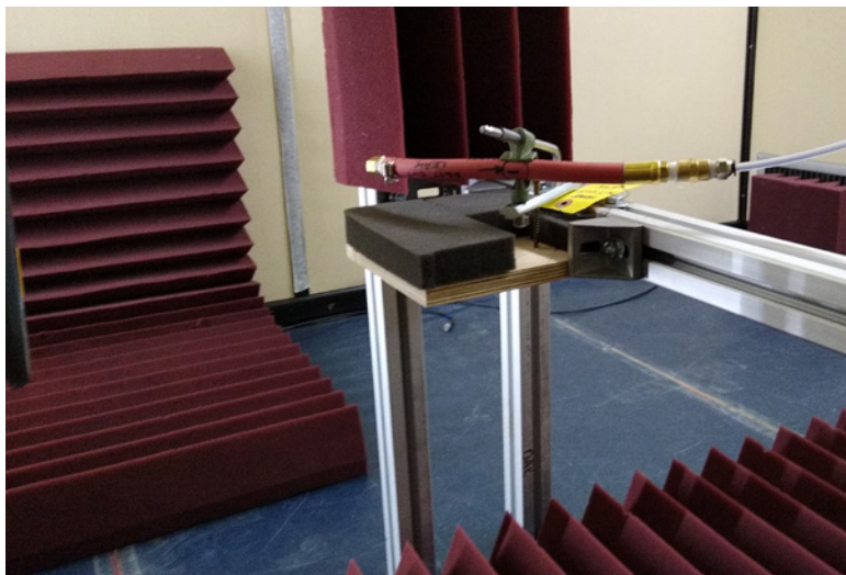
รูปที่ 3: การวัดประเภทการรั่วของท่อที่มุม 30 องศา
