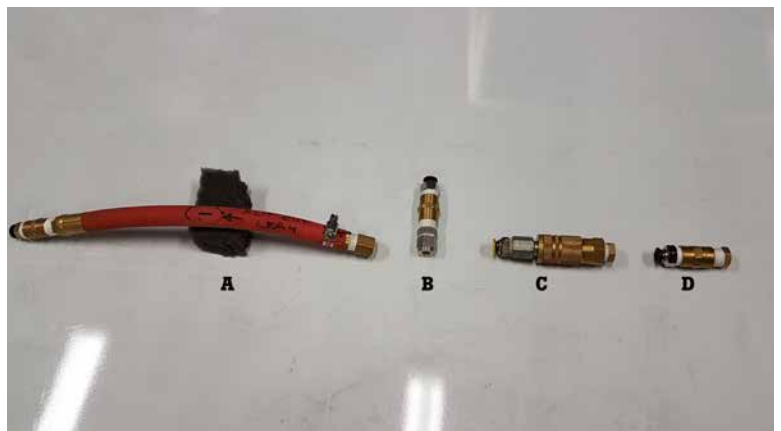
Hình 5: Bốn loại rò rỉ được điều tra trong thử nghiệm: ống mềm (a), đầu hồ (b), kết nối nhanh (c) và khớp nối có ren (d).
