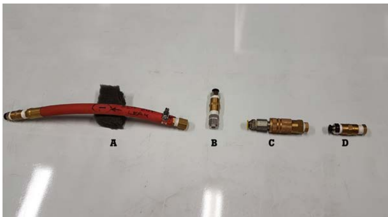
Obrázek 5: Čtyři typy netěsností, které byly zkoumány během zkoušek: hadice (a), otevřený konec (b), rychlé spojení (c) a závitová spojka (d).
