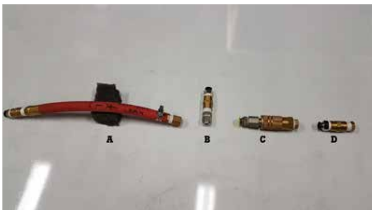
Figur 5: de fire lekkasjetypene som ble undersøkt i løpet av eksperimentene: slange (a), åpen ende (b), hurtigkobling (c) og gjenget kobling (d).
