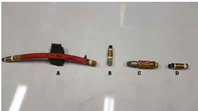
Rysunek 5: Cztery typy przecieków, które poddano badaniom: wąż (a), otwarty koniec (b), szybkozłącze (c) i złącze gwintowane (d).
