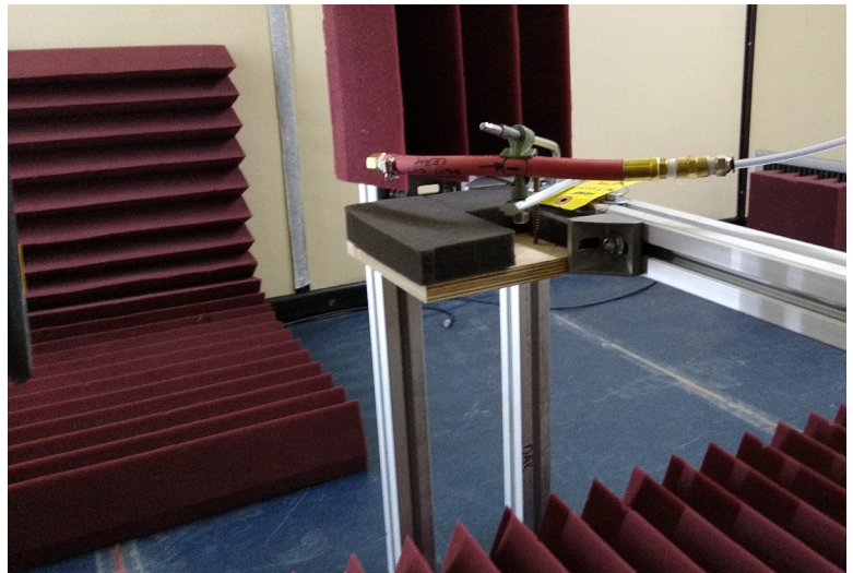
Bild 3: Mätning av läcka av slangtyp vid vinkeln 30°.
