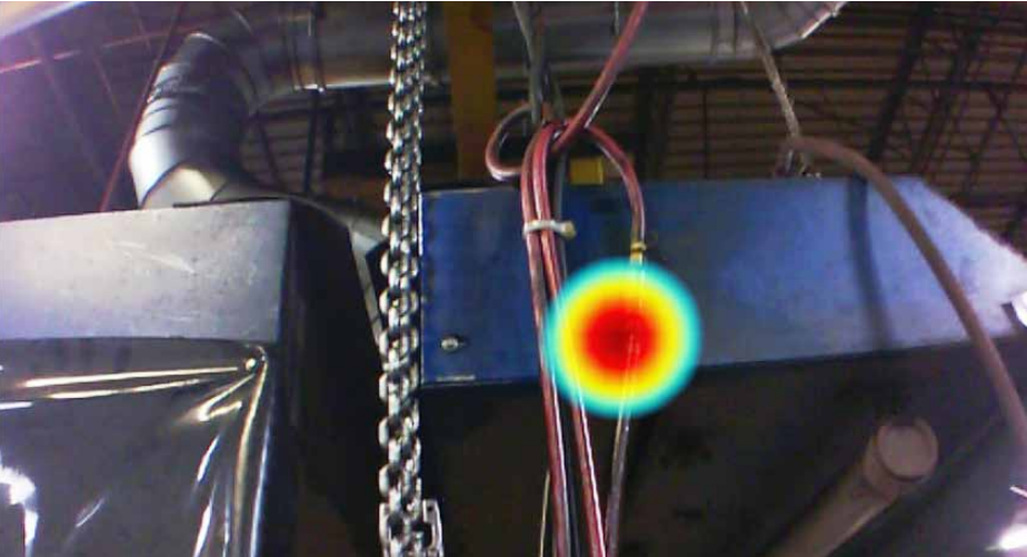
ii900 Endüstriyel Akustik Görüntüleme Cihazı ile çekilen görüntüde, endüstriyel bir ortamdaki hava sızıntısı yer almaktadır.
