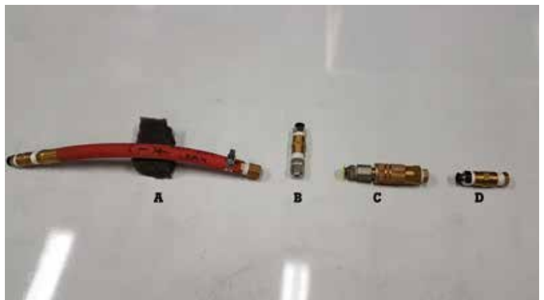
圖 5：實驗期間調查的四種洩漏類型：軟管 (a)，開口端 (b)，快速連接 (c) 與螺紋耦合 (d)。
